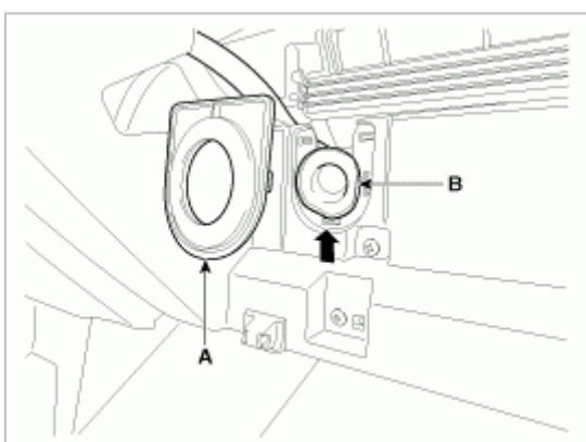
7. 拧下固定螺钉后，拆卸手套箱壳 (A)。
