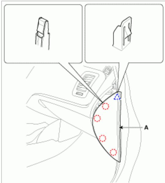
5. 拆卸手套箱软管盖 (A)。
