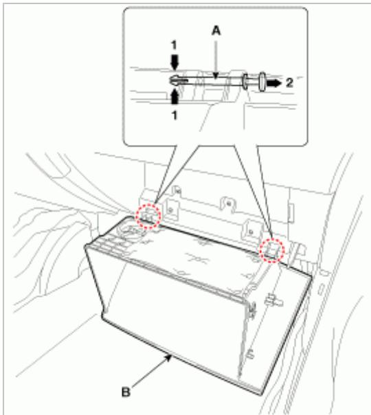
4. 使用螺丝刀或拆卸工具，拆卸仪表板侧盖[右] (A)。
